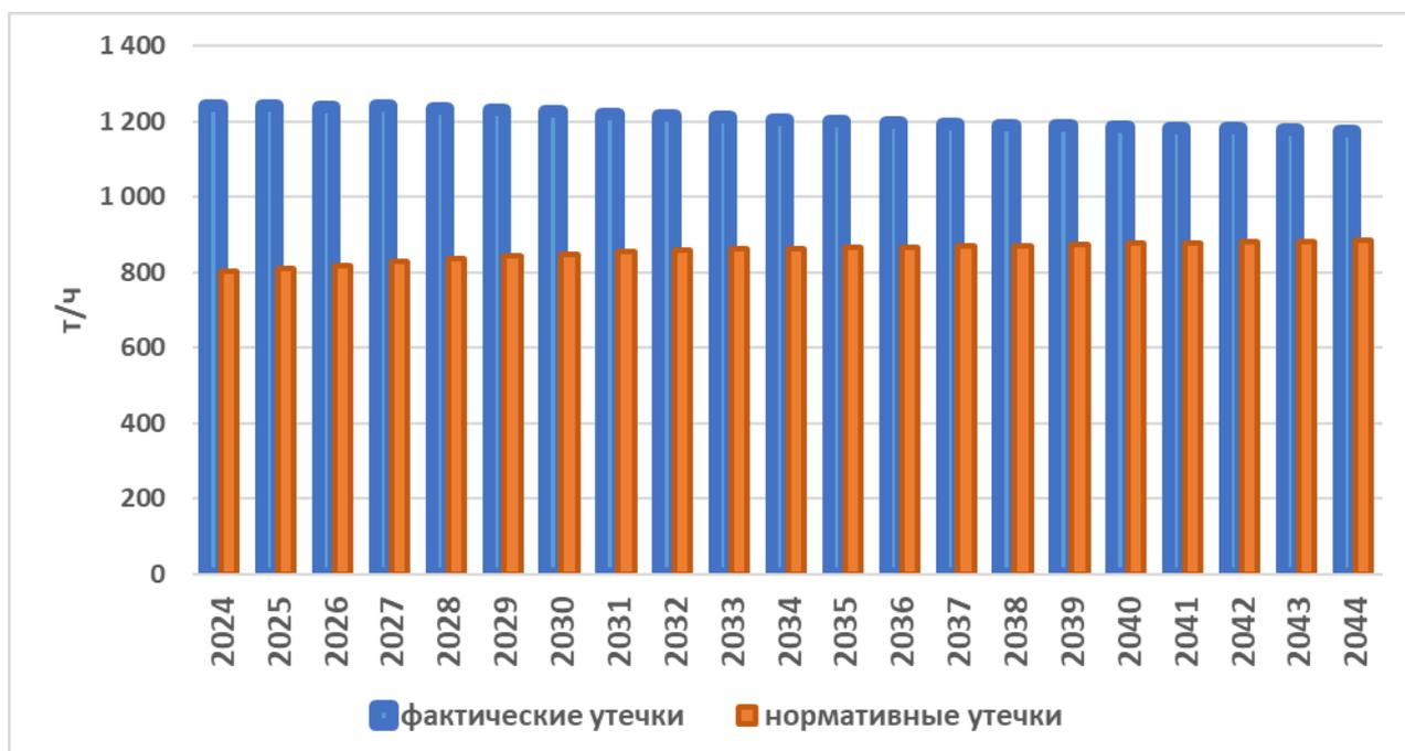
Рисунок 8.1 – Утечки из тепловых сетей
